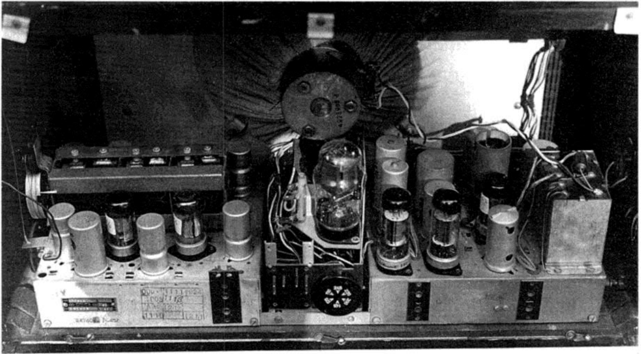
Bild 5: Chassis des BX760. Links der "6fach-Drehko" (Zum Schutz vor Mikrophonie in Stahlfedern aufgehängt). Ganz rechts der gekapselte Ausgangsübertrager. Links darüber die "Zusatzmasse" (geschlitztes Eisenrohr) auf der NF-Vorröhre.
