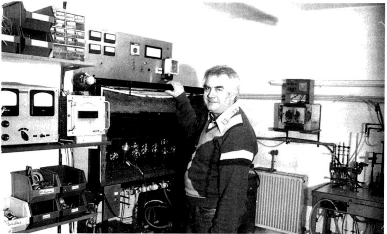
Bild 4: Franz Pemmerl am Ausheizofen beim Ausglühen der Systeme
