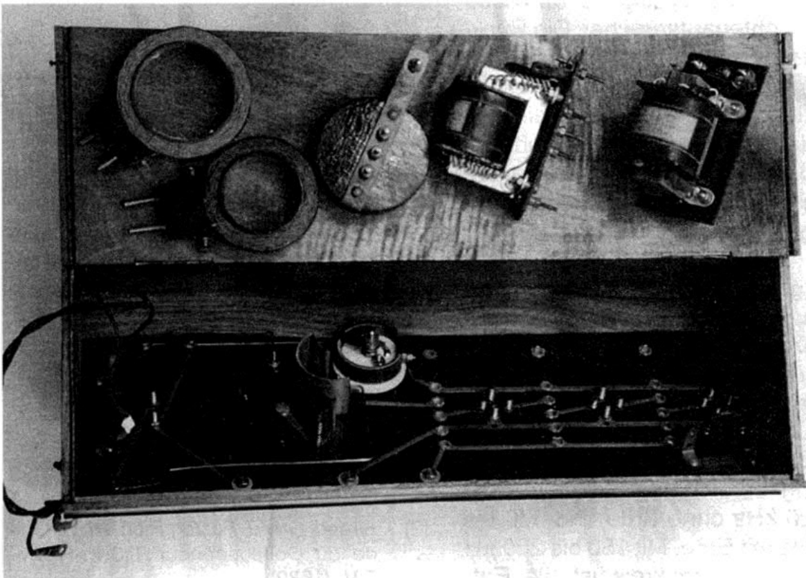
Bild 3: Gesamtansicht der Schaltung. Die Leiterbahnführung ist genial einfach. Sowohl die Audionkombination als auch die NF-Trafos sind steckbar, quasi modular.
